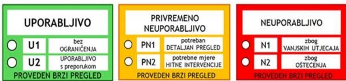
(1) **N1 – Neuporabljivo – zbog vanjskog utjecaja** – Građevina je opasna zbog mogućnosti urušavanja masivnih dijelova susjedne građevine. Uslijed takve opasnosti preporuka je da se u takvim zgradama nikako ne boravi.
