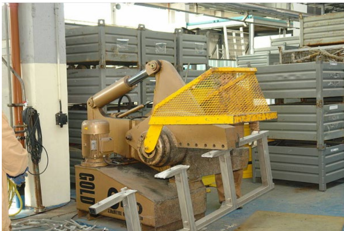
Slika 5-3: Hidraulične škare (izvor: EWN)
