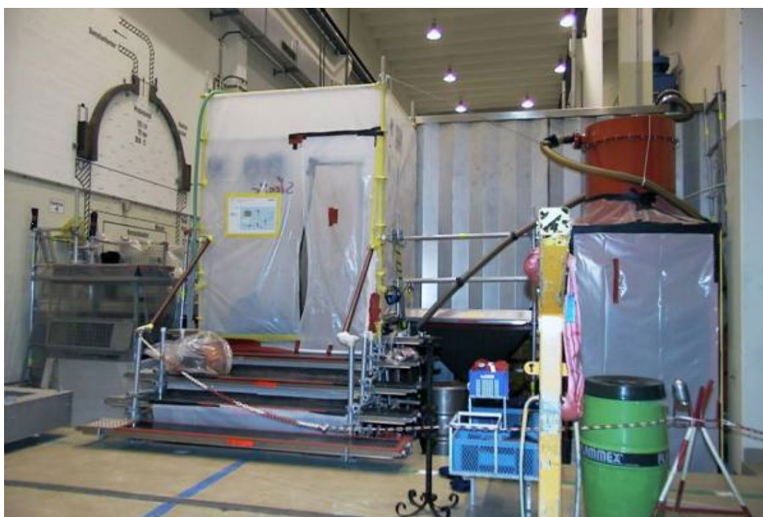
Slika 5-10: Kavez za obradu mlazom u NE-u Kahl
