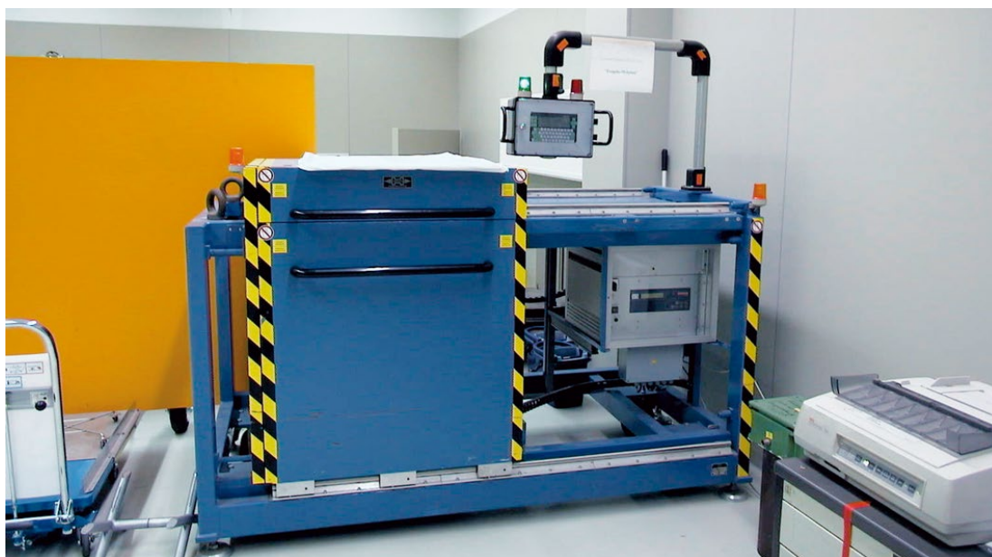
Slika 5-14: Mjerno postrojenje za slobodno otpuštanje komponenata (izvor: NE Kahl)
