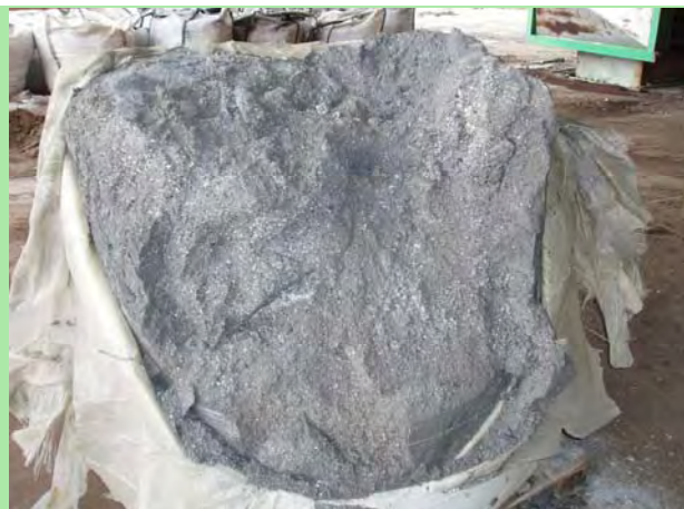
I. faza sanacije bivšeg postrojenja PUTO prepakiranjem opasnog otpada (solidifikat filter pepela)
