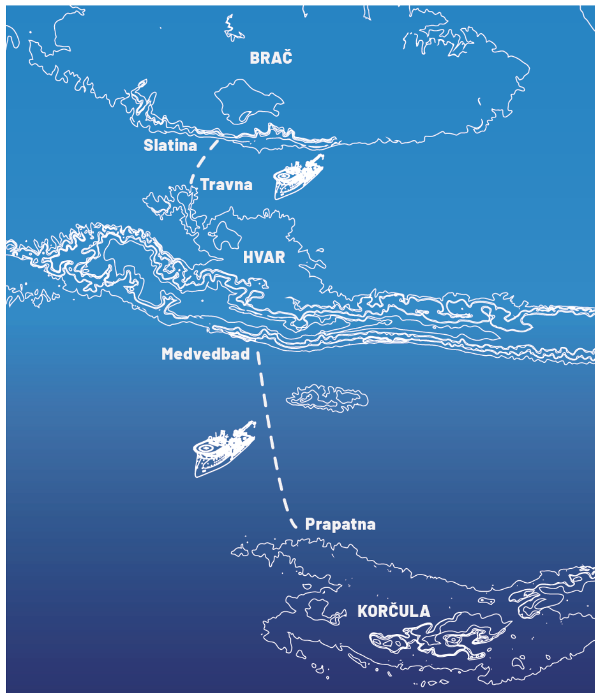
110 kV kabel Brač - Hvar - Korčula
